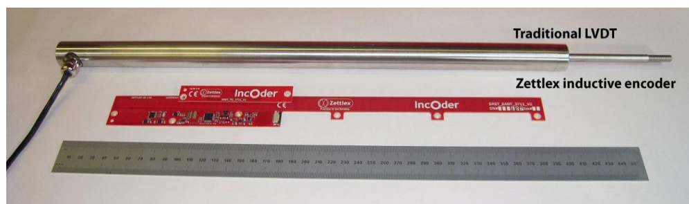
Abbildung eines herkömmlichen LVDT (oben) und eines Linearsensors von Zettlex (Mitte). Lineal darunter zum Größenvergleich.
